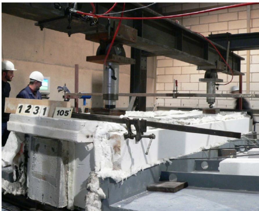
Figure 9 : Face non exposée au feu au temps 105 minutes
